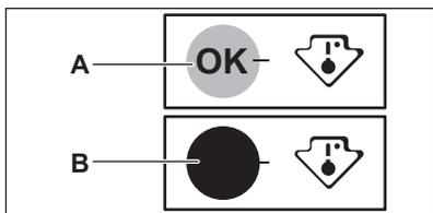
**i** Het is normaal dat de indicator geen OK aanduidt nadat u voedsel in het apparaat geplaatst hebt of na herhaaldelijk openen van de deur. Wacht minstens 12 uur voordat u de temperatuurregelaar opnieuw aanpast.
